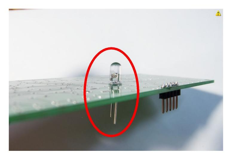
12) Install temperature sensor IC1 DS18B20 on BOTTOM side of PCB:
