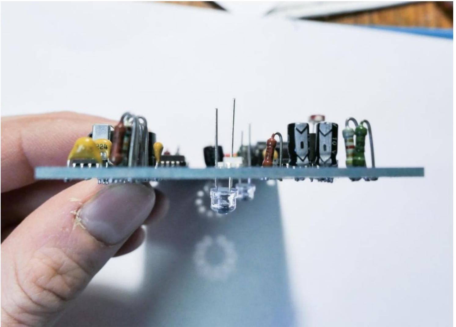
12) Install temperature sensor IC1 DS18B20 on BOTTOM side of PCB:
